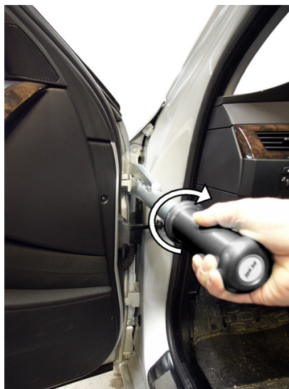
② Serrer en tournant simplement la poignée
