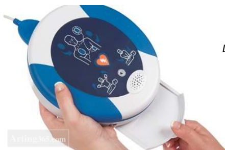
Emplacement du Pad Pak
