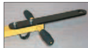
Timon directionnel des SX15 et SX20 équipé d'une plaque de liaison pour engin motorisé.
