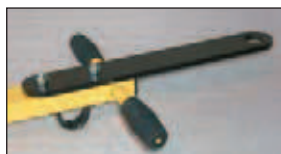
Timon directionnel équipé d'une plaque de liaison pour engin motorisé.
