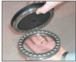
Plateau tournant du patin avant supporté par un roulement à billes de grande dimension sur l'ensemble de la gamme.
