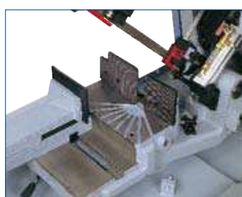
Coupe 45° à gauche et 60° à droite par simple mouve- ment latéral de l'étau
